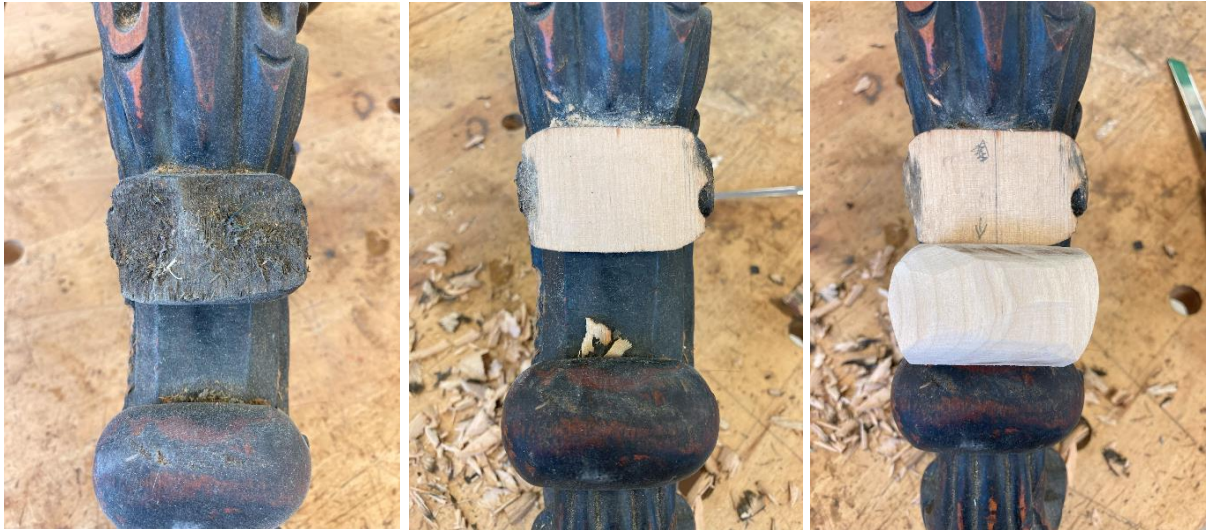
Foto 61. Kulunud osa. Foto 62. Tasandatud peitliga. Foto 63. Uus klots.
