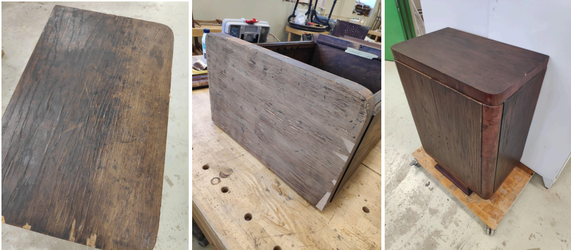
Funk stiilis euroopa pähkli ning tammespooniga öökapp. Kapi pealse tammespooniga parandustükkide lõikamine, liimimine kondiliimiga ning peitsimine.
