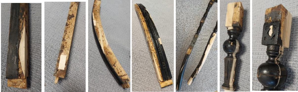
Foto 1-7 Toolile oli vaja teha muuhulgas 25 erinevat plommimist. Osa neist on paigutatud peiteldatud ja osa freesitud avadesse. Lõhed on täidetud puukiiludega. Et plommid tugevalt oma kohal püsiks, kasutan nende kinnitamiseks B3 puiduliimi
