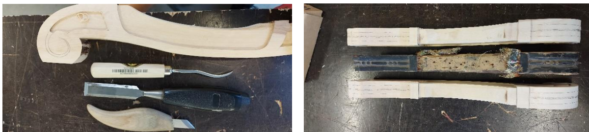
Foto 39-40 Historistsilikule toolile valmistasin puudunud käetoed analoogse tooli eeskujul. Suures osas on detailid valminud masintöötlemisel – kasutatud on paksusmasin, formaat-, järkamis- ja lintsaagi, lintlihvijat ning käsifreesi
