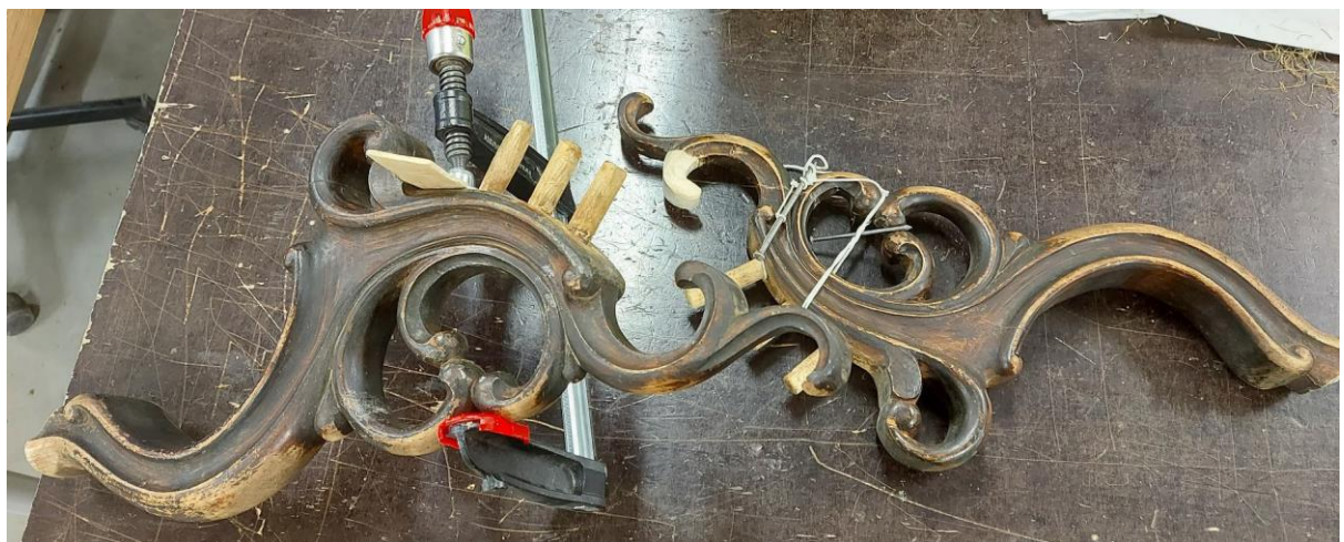
Foto 35-39 Puuduvate osade valmistamine ja kinnitamine
