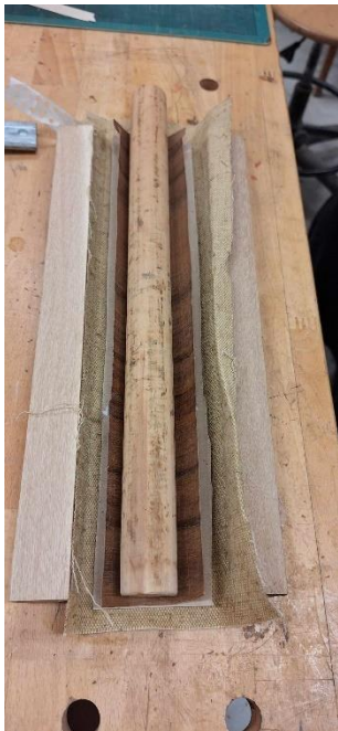
Foto 89-91 Treitud labidavarrele sai liimitud pähklispoon kasutades presendist ja puidust isevalmistatud rakist
