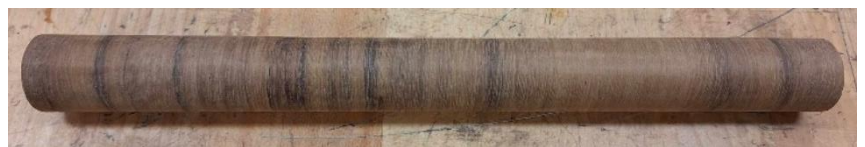
Foto 89-91 Treitud labidavarrele sai liimitud pähklispoon kasutades presendist ja puidust isevalmistatud rakist
