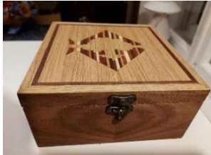
Foto 80-84 Puitkarp. Lõikasin kalasabatappidega karbi kaanele intarsiatehnikas oma firma logo. Katsin küljed spoonisärkidega ja viimistlesin linaõliga
