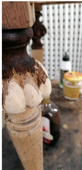
Puidulõike parandused säilinud jalal
