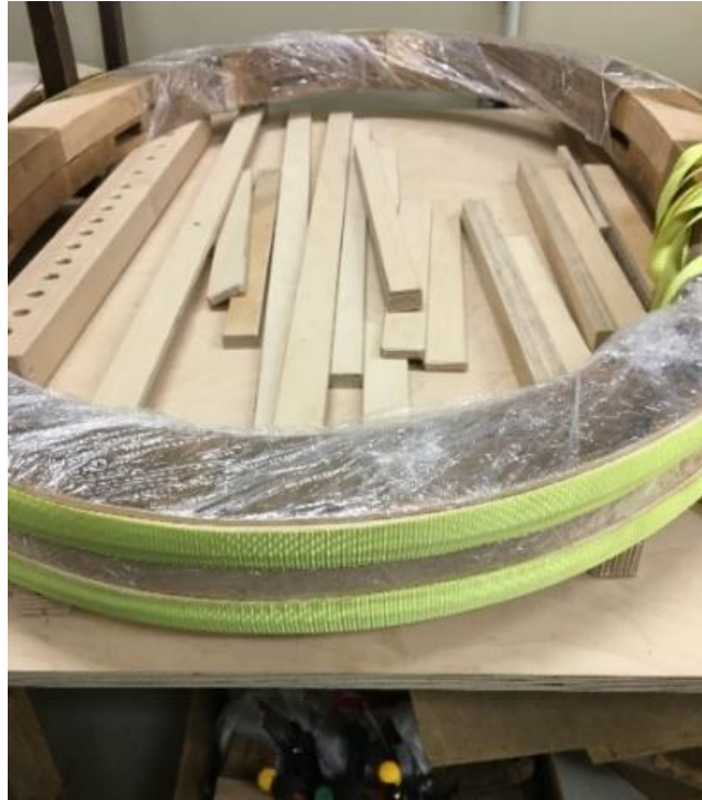
Pilt 10 – niisutatud liistud on koormarihmadega painutatud raamile
