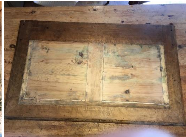
Pilt 50 – puhastatud pind, lõhedesse on liimitud spooniribad
