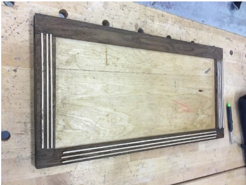
Pilt 36- liimitud ribad kõmmeldumise eemaldamiseks
