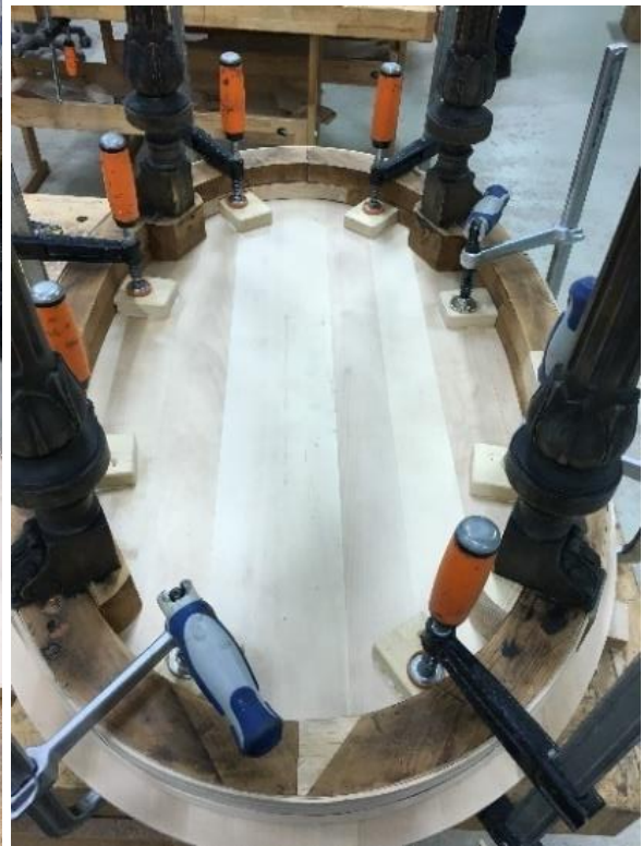
Pilt 20 – lauaplaadi paigaldamine kutsikatega
