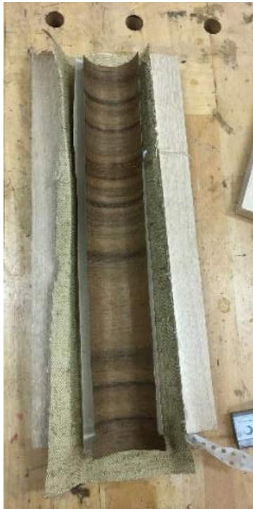
Pilt 84- spoonisärk enne liimimist Pilt 85 – valmis liist
