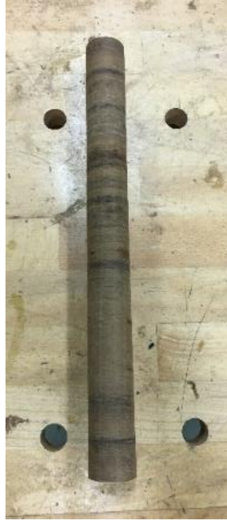
Pilt 84- spoonisärk enne liimimist Pilt 85 – valmis liist
