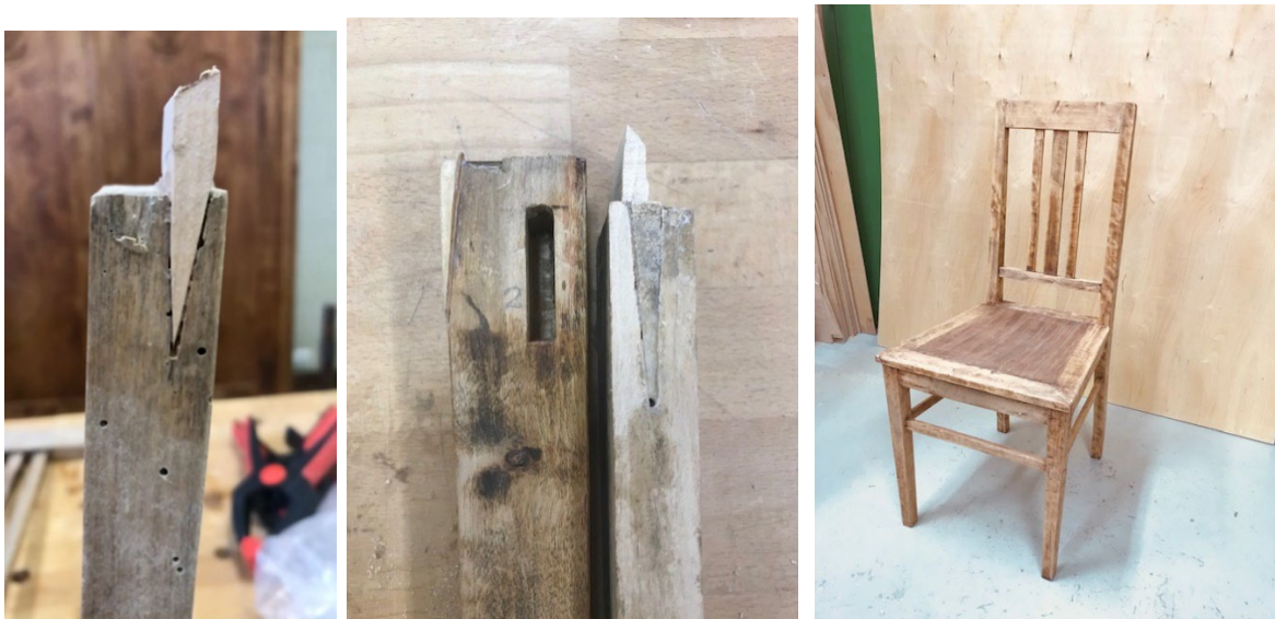
Lauajalale proteesi valmistamine. Kasutatud treipinki.
