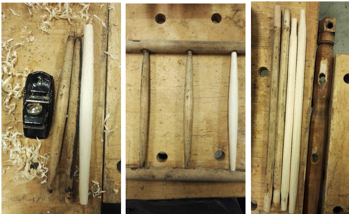
Kolmanda korjupulga hõõveldamine ja sobivuse proovimine ning kaks uut tooli jalgade vahelist pulka
