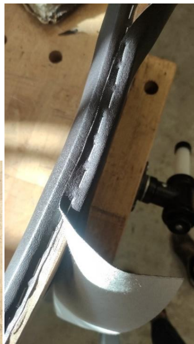
Art deco tooli seljatoepolstri tihiniidid ja kattedkanga klammerdamine
