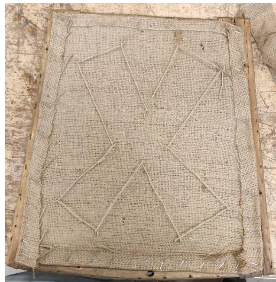
Sadulavöödele kinnitatud tihedam kotirije ja tihiniidid
