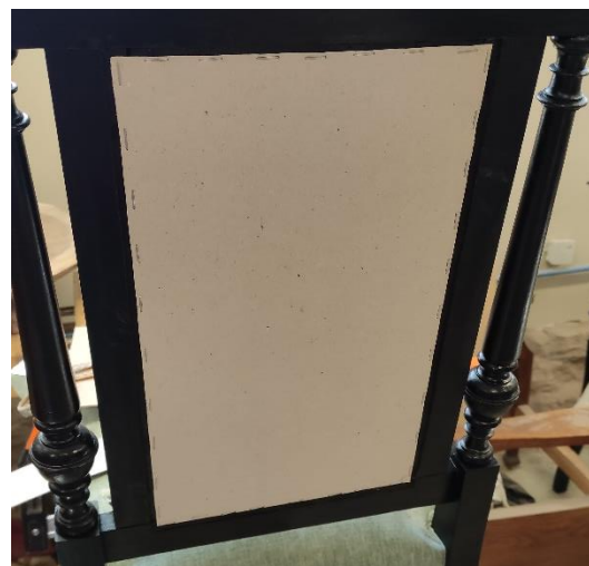
Seljatoe polstri tegemise etapp ja polstriraami tagaküljele klammerdatud papp
