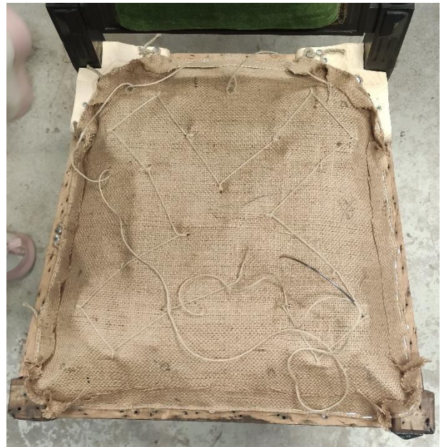
Kotiriide külge seotud vedrud ja tihiniitide õmblemine
