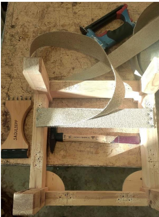
Istmeraamile sadulavööde paigaldamine.
