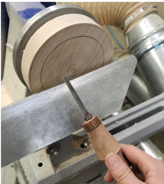
Krooni ülemise osa treimine ja selle profiilijoonise šabloon
