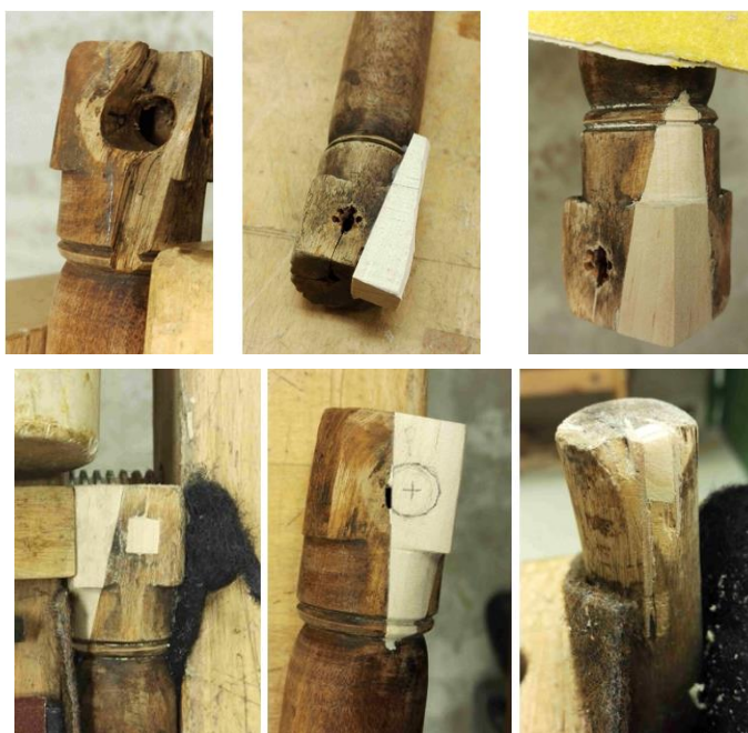
Puiduparandused ja plommimised tooli jalgadel
