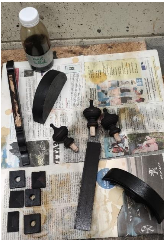
Eelnevalt krunditud detailide lakkimine
