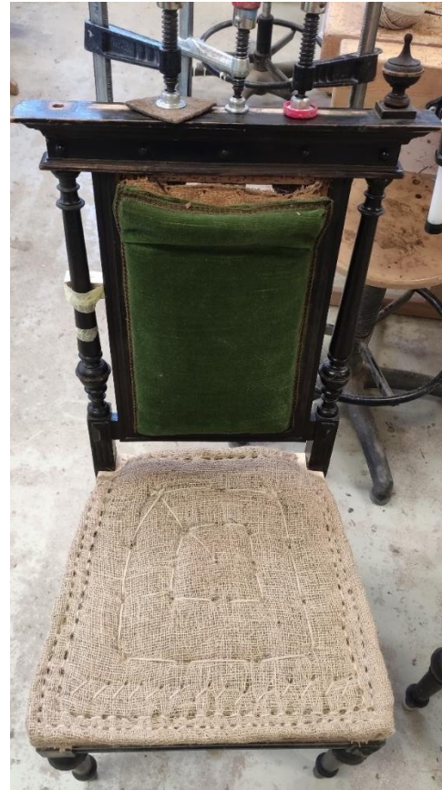
Seljatoeraami ülemise liistu kinniliimimine
