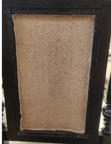
Teise tooli seljatugi tagantvaates ja selle raamile klammerdatud tihe džuutkangas
