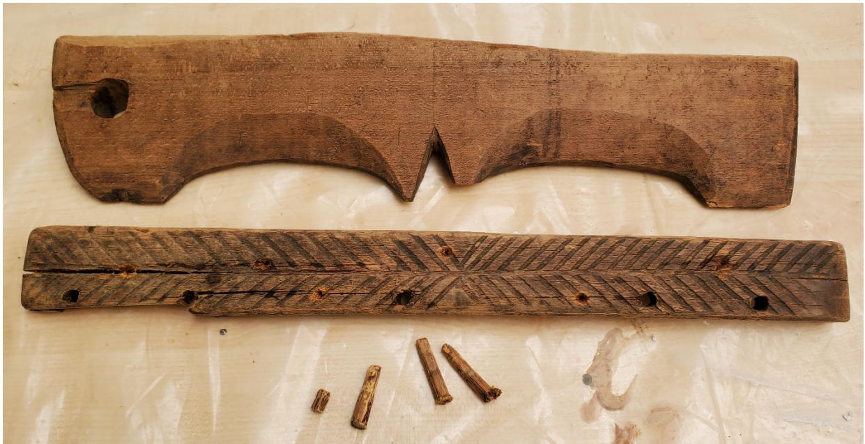
foto 51 Liimisin murdunud osad kokku (foto 52) ja valmistasin puuduvad osad (foto 53).
