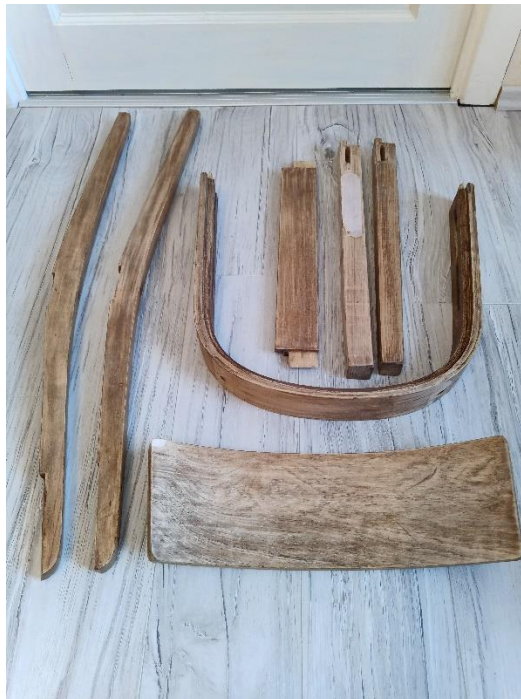
Detailid on arvestades edasist viimistlust puhastatud piisava astmeni.
