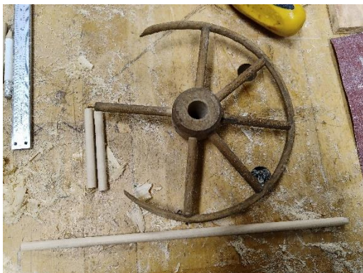
Välja on lõigatud puuduvad kodarad. Pikem varras ootab aurutamist ning
