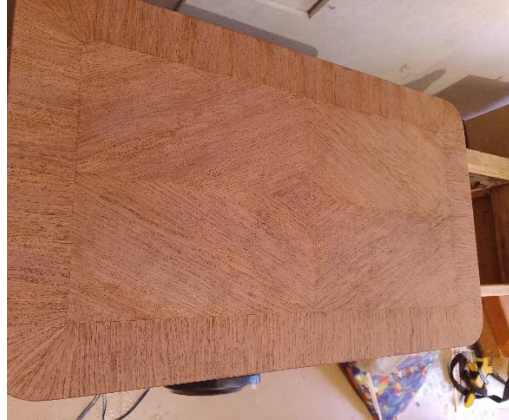
Ülemise tasapinna spoonisärk on liimitud ja spooniteip eemaldatud.
