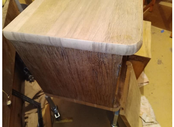
Fragment töö käigust- meigasserval ning töötasapinnal spoon osaliselt vahetatud. Näha on spooniparandused põrandaplaadi servaspoonil.
