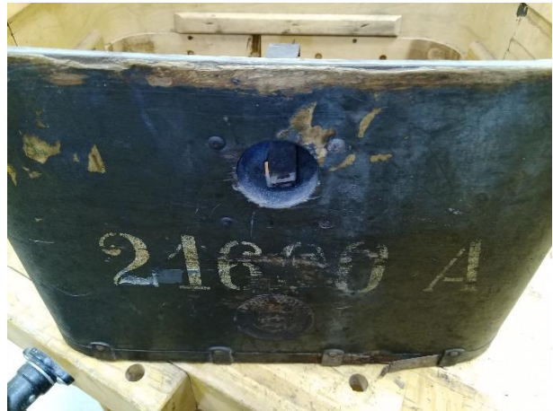
Üldvaade aktsiisikastile. Parem aluses ääres on näha, et metallriba on läbi roostetanud.
