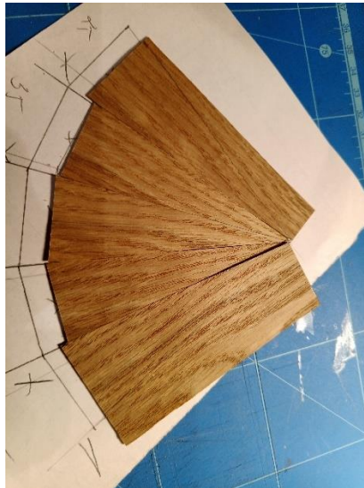
Ülemise tasapinna kumernurga spooni koostamisel kasutasin šablooni mille järgi spooni lõigates sain igasse nurka ühesuguse ja korrektse nurga.
