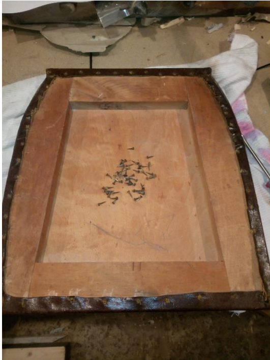
Istmeplaadi polstri lahti võtmine tuvastamaks polstri seisukord.
