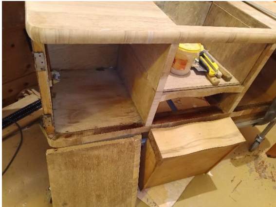
Fragment töö käigust- näha on paika liimitud spoon sahtlil ning kapi fassaadil tehtud spooni parandused.
