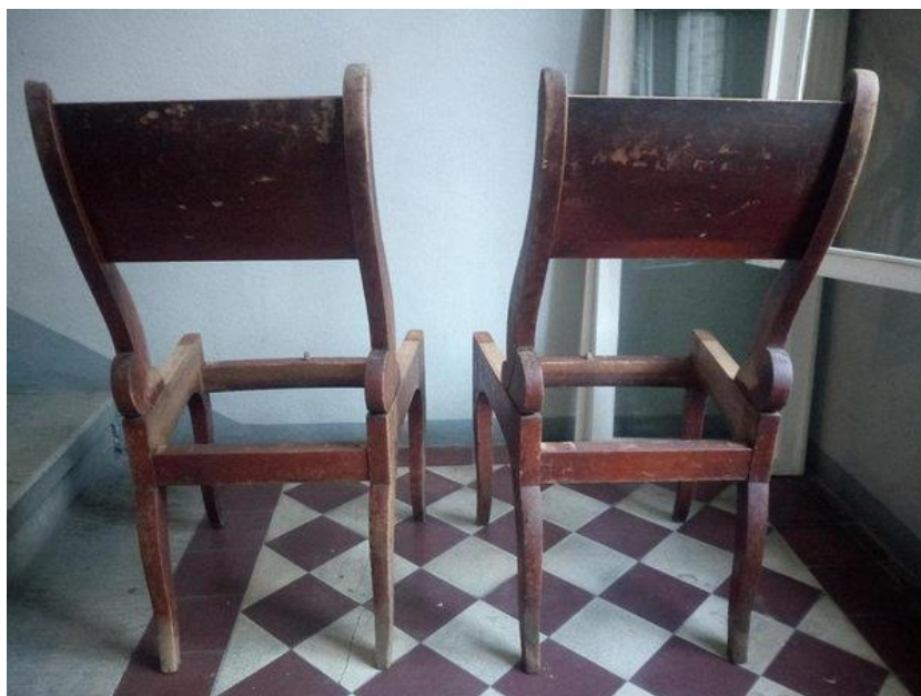
Vasakpoolse tooli seljatoe ülemise ääre lähedal ning keskel näha kaussjad putuka kahjustused
