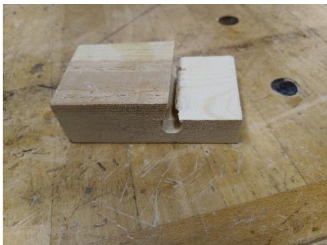
Rakis vankri rataste detailide valmistamiseks. Rakises oleva augu kõrvale, välja saetud kohale kinnitatakse pitskruviga õige nurga all hõõvli tera. Analoogselt valmistatakse vibunooli.
