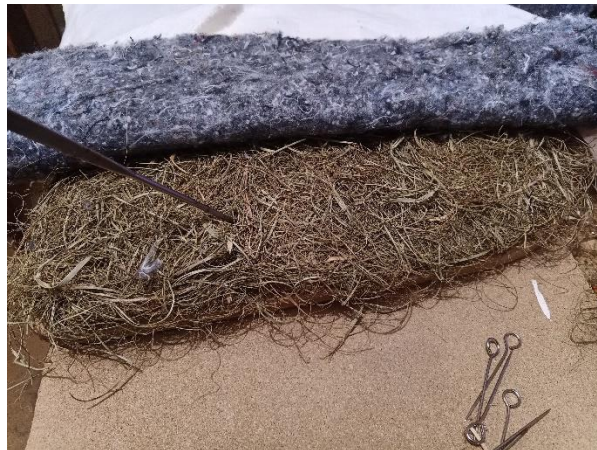
Näide merirohu ja halli vati kihist, mis jääb vaheriide alla.
