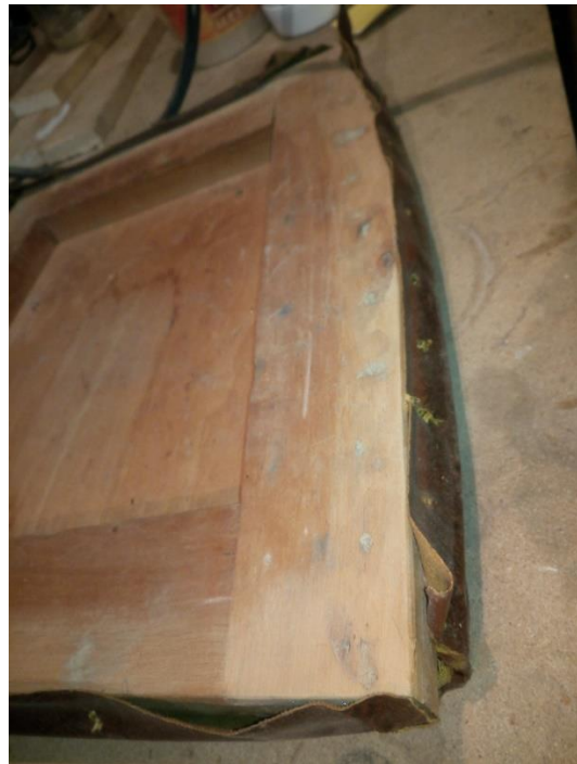
Istmeplaatide vanad täkside augud on pahteldatud, välistamaks uue katte kinnitamisel täksi sattumist vanasse auku (halb kinnitus) ning tagamaks istmeplaadi korrektsem välimus.
