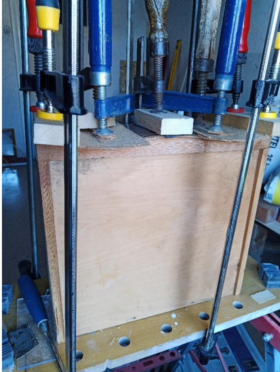
Sahtli fassaadi katva vineeri vormimine ja liimimine.
