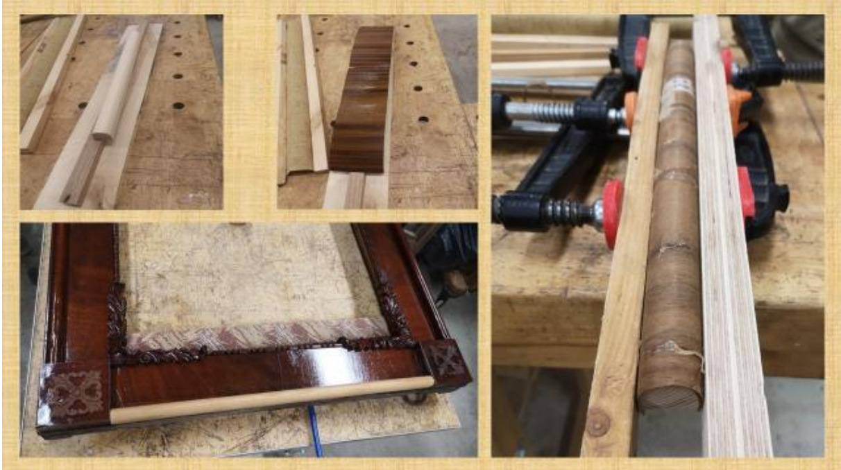
Pilt 40: Poolümarliistu rakise valmistamine, vineerimine ja selle kasutamine esemel
