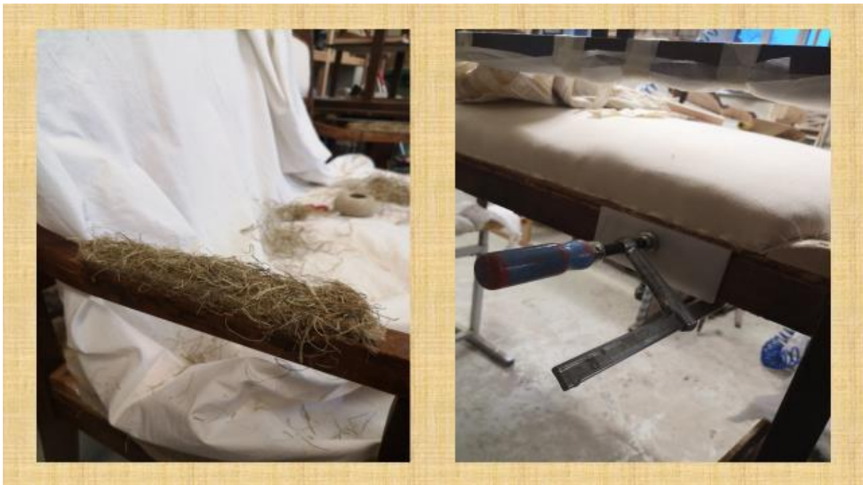
Pilt 11: Käetugede polsterdamine ja spooniparandused sarjale
