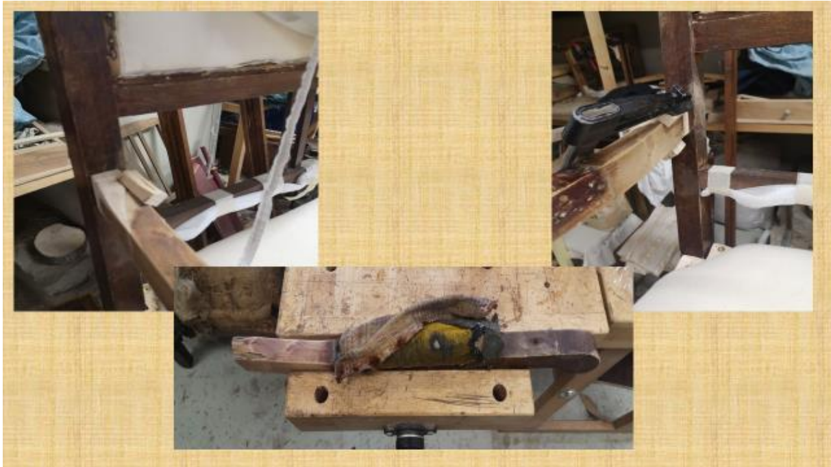
Pilt 10: Täiendav puiduparandus vasakule käetoele
