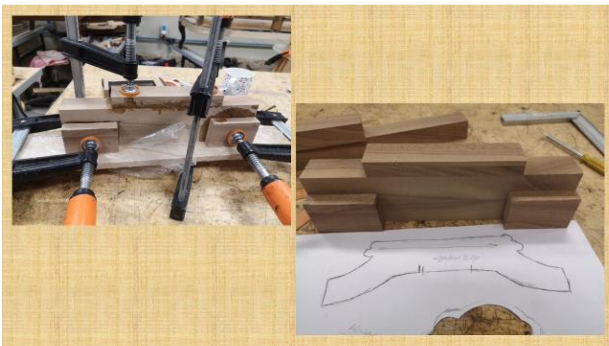
Pilt 31: Seljatoe krooniosa kokku liimimine pähklipuidust
