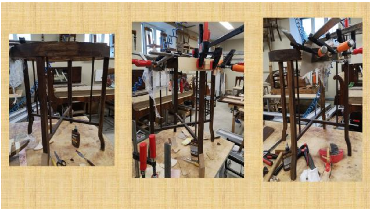
Pilt 42: Juugendliku kohvilaua jala proteesimine ja sarja spooniparandused kumeral pinnal
