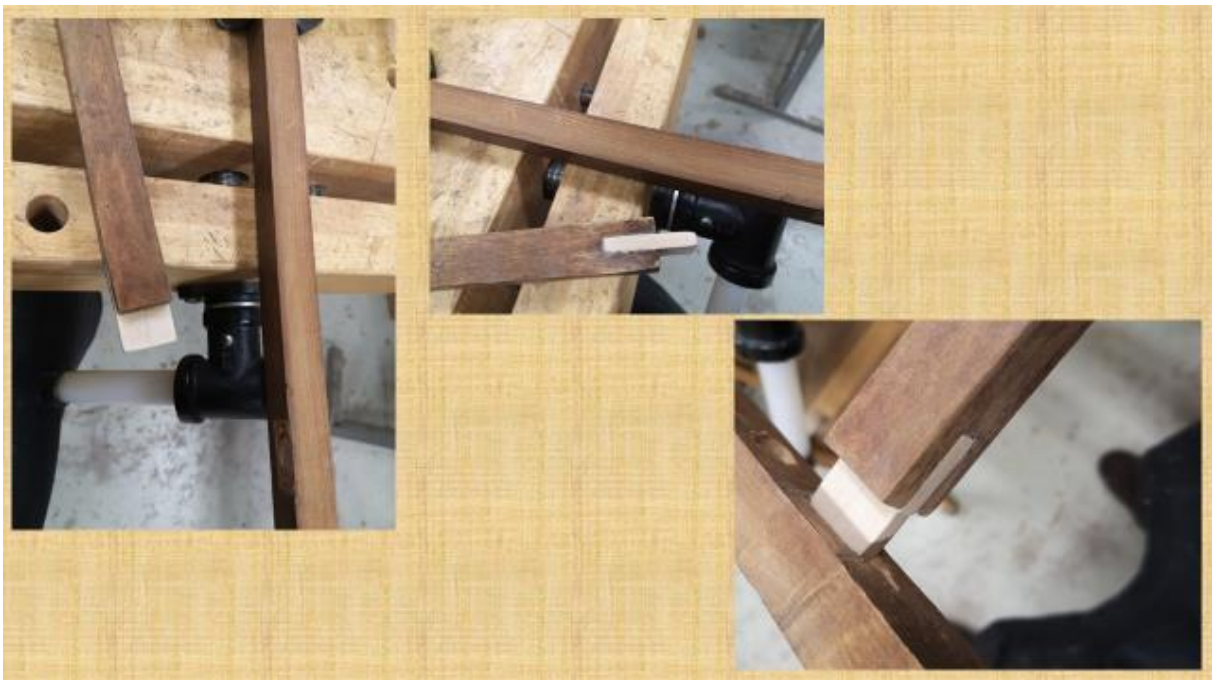
Pilt 20: Tapikeele tegemine sirmi murdunud tapile
