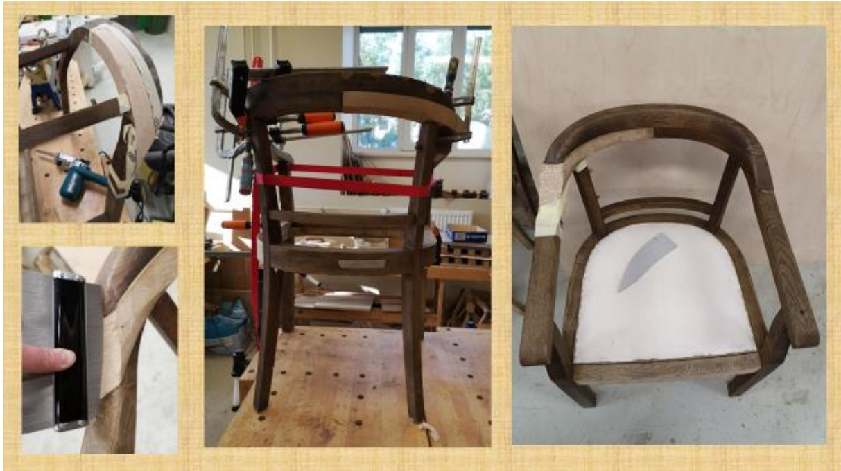
Pilt 25: Funkstiilis tooli vormilõigatud detaili ühendamise detailidega
