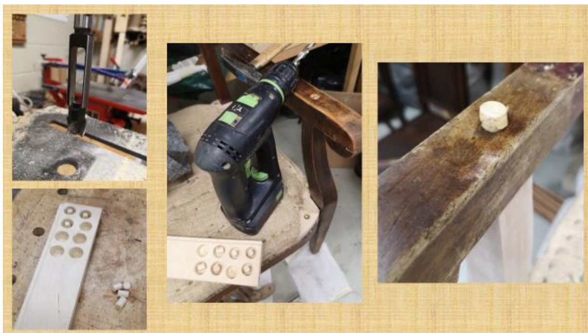
Pilt 8: Tüüblipunnide valmistamine ja paika liimimine
