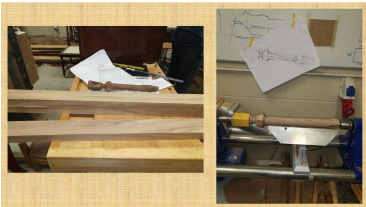
Pilt 27: puidu mõõtu arvestamine/lõikamine/ liimimine ja esijala treimine
