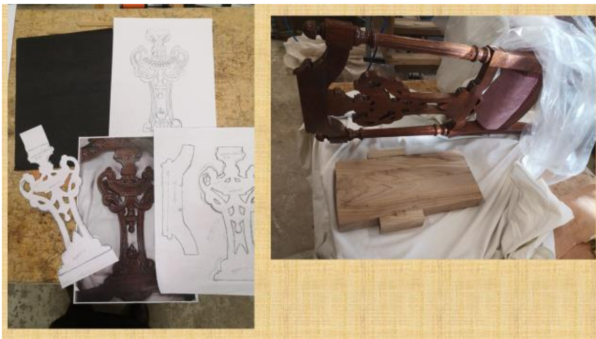
Pilt 30: Trofeosa šabloonide võtmine, puidu vormi ettevalmistus lõikamiseks
