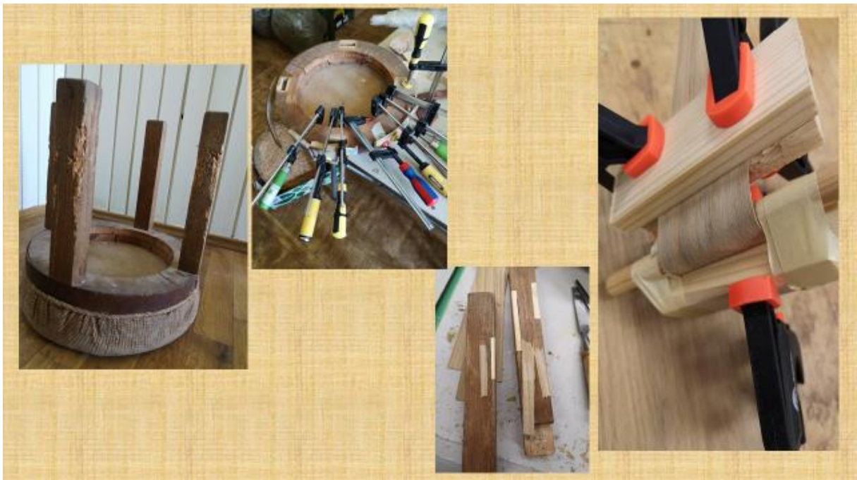
Pilt 39: Art deco stiilis järi spooniparandused kumer- ja ümarpinnal. Rakise näidis
