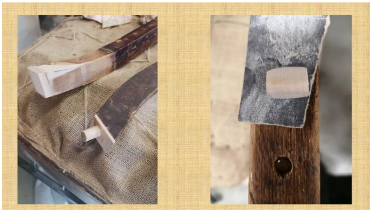
Pilt 7: käsitsi voolitud tüüblid käetugede tagumiste otsade kinnitamiseks
