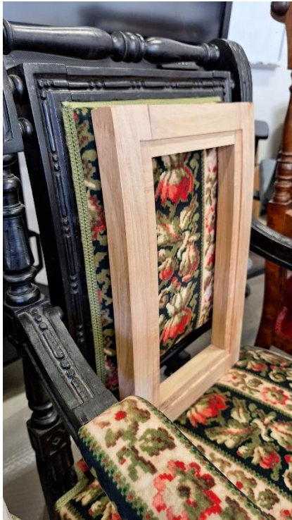
Joonis 60 Polstriraami sobivuse proovimine eeskujuks oleval toolil
