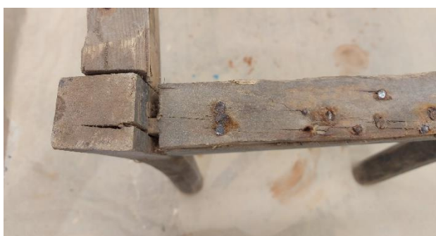
Joonis 21-22 Lahtised tappühendused
