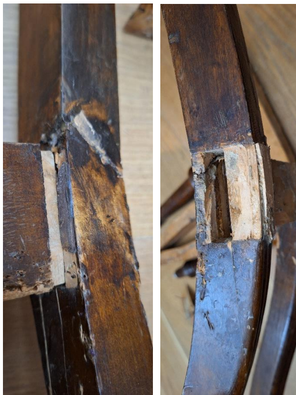
Joonis 16-17 Oksakoht tagumisel paremal jalal
