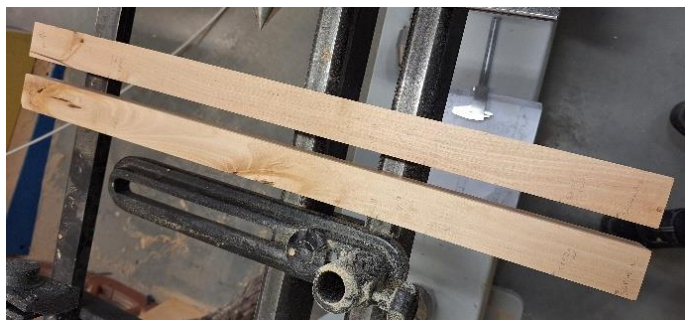
Joonis 33-36 Seljatoe ülappuu valmistamise etapid
