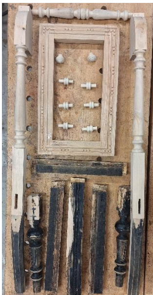
Joonis 65 tooli detailid enne liimimist.
