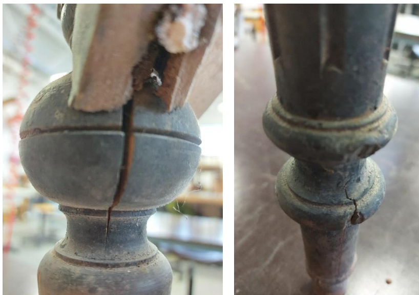
Joonis 23-24 Lõhed esijalgadel
