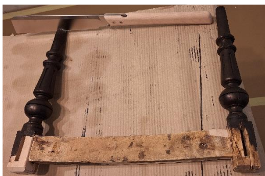
Joonis 72 Esijalgade mõõtu löikamine
