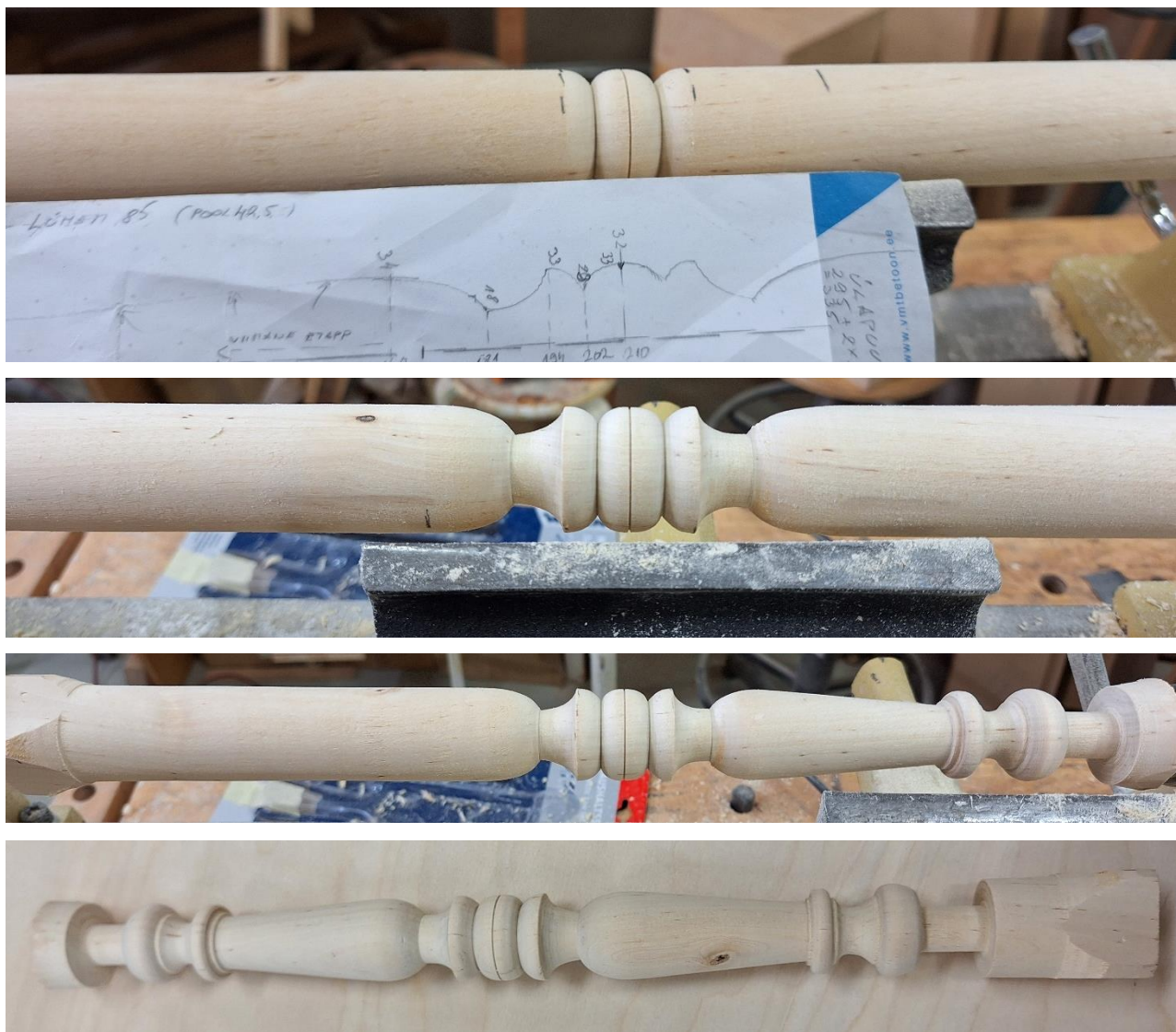
Joonis 33-36 Seljatoe ülappuu valmistamise etapid
