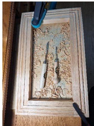
Joonis 62-64 Nöör-pärl ehislõike tegemise faasid
