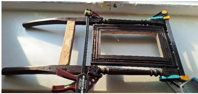
Joonis 70-71 Seljatoe ja esijalgade liimimine esimeses etapis
