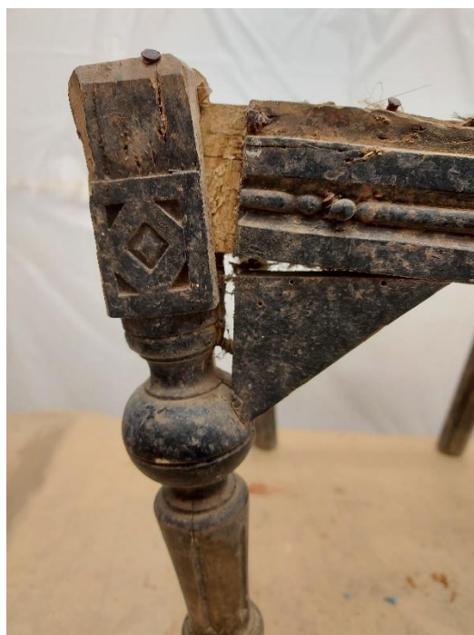
Joonis 18-20 Tugevdusklotsid, avatud tapid ja murdumisesl eemaldunud osa puudumine
