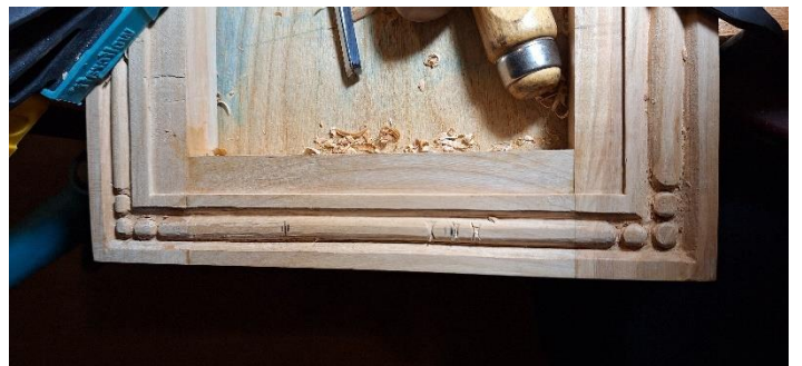
Joonis 62-64 Nöör-pärl ehislõike tegemise faasid
